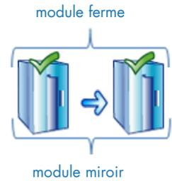
Le module applicatif miroir s'exécute uniquement sur le serveur 1. Les clients de ce module applicatif sont automatiquement connectés sur le serveur 1 grâce à une adresse IP virtuelle de type primaire/secours. SafeKit réplique sur le serveur 2, en temps réel à travers le réseau, les fichiers ouverts par l'application. Seules les modifications faites par l'application sont répliquées, limitant ainsi le trafic.
